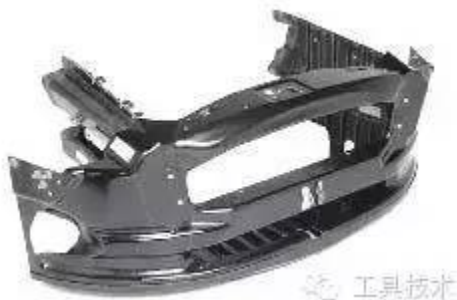
圖 4 阿斯頓·馬丁 Vanquish 跑車的前部緩衝結構主要採用碳纖維複合材料製成
